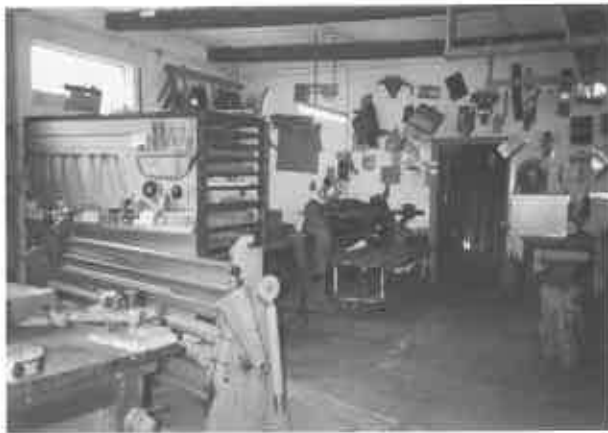
Klempnerwerkstatt mit 2-Meter Abkantbank und 2-Meter Tafelschere bis 1994.
